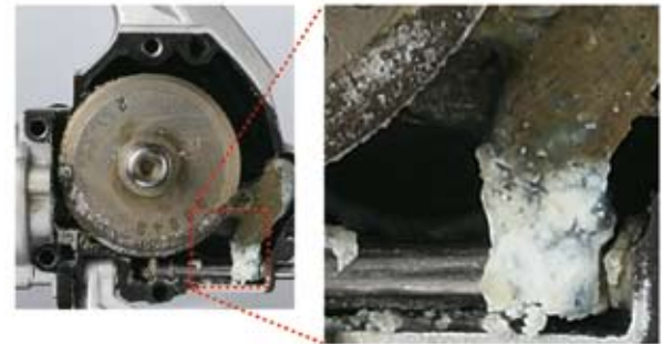
Vergleich von Rollen mit MAG SEALED und ohne. Quelle DAIWA Intern - Service-Abt.
